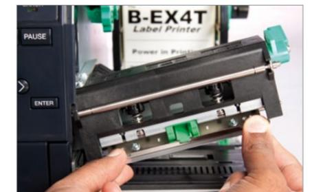
La funcionalidad de cabezal de impresión auto-ajutable reduce el tiempo de mantenimiento al mínimo
